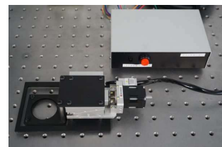
35mmディッシュ用Zステージ + Zステージ用中継BOX
